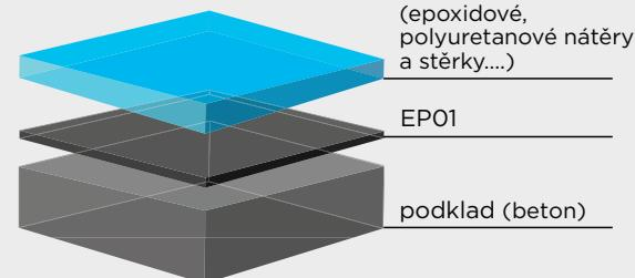
**2-komponentní epoxidová základní penetrace vhodná na suché betony s vlhkostí do 6% a jiné minerální podklady**
